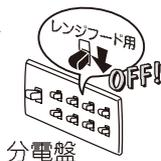
完了後は分電盤のレンジフード専用ブレーカーを入れて下さい
