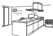
空気の取り入れが不十分ですと換気性能が低下したり、レンジフードに異音・振動が発生する場合があります
