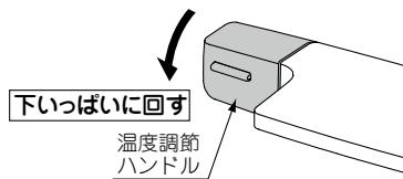
2. 切替ハンドルを下側(吐水口)へ回し、全開で吐水します。
