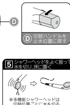
注<sup>1</sup> 水抜栓が固い場合は、マイナスドライバーを使用してください。
