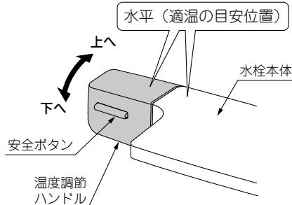
温度調節ハンドルには、安全ボタンがついており、「水平」位置を少し過ぎたところで一度ロックされます。さらに高温側に回したいときは、安全ボタンを押しながら回します。
