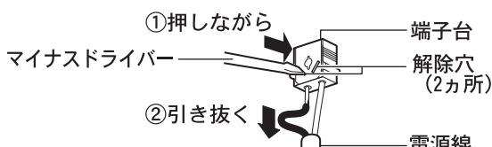
マイナスドライバー等の先端で解除穴を押しながら片方ずつ電源線を引き抜く
