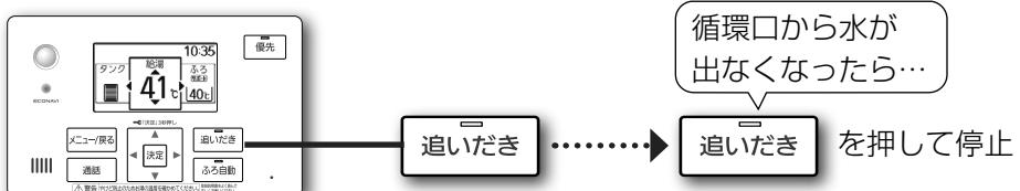
●ポンプが作動し、配管に残っている水を浴そうに排水します。
