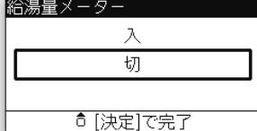
※入：給湯栓の開閉時に、当日の使用湯量を表示します。
