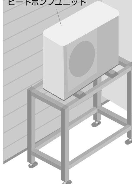
●ヒートポンプユニット内の「空気抜き」を確実にしないと、ヒートポンプ給湯機が故障する原因となります。
