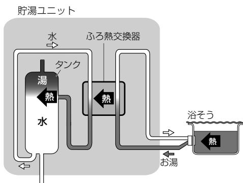
浴そうのお湯の熱でタンクの水を温めます。タンク内の熱が増えるので、沸き上げに必要な電力量を減らすことができます。
