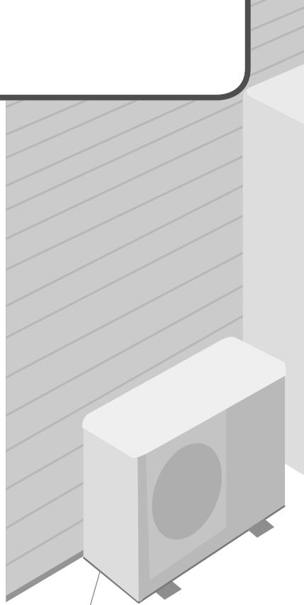
●ヒートポンプユニット内の「空気抜き」を確実にしないと、ヒートポンプ給湯機が故障する原因となります。
