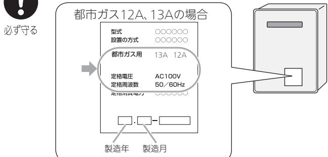
表示のガス種および電源が一致しないと、不完全燃焼による一酸化炭素中毒になったり、異常点火でやけどしたり、機器が故障する場合があります。
