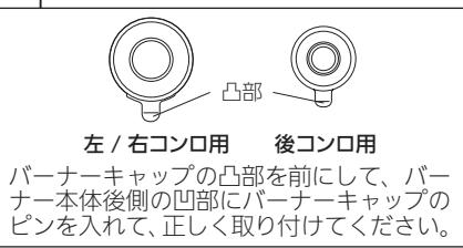
バーナーキャップの凸部を前にして、バーナー本体後側の凹部にバーナーキャップのピンを入れて、正しく取り付けてください。
