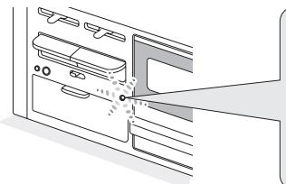
〈点滅〉 ……電池交換サインが点滅したら、新しい単1形アルカリ乾電池(1.5V)2個を準備してください。
