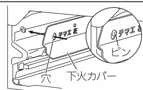
2. 「テマエ左」または「テマエ右」刻印を手前にして、ピンに穴(1カ所)をかける。図は下火カバー(左)を示します。下火カバー(右)も同様に右側へ取り付けてください。
