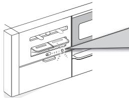
電池交換サインが点滅したら、コンロやグリルが使用できなくなります。早めに新しい単1形アルカリ乾電池(1.5V)2個と交換してください。
