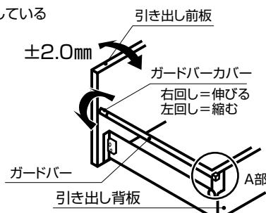
ガードバーを回して傾きを調整します。
