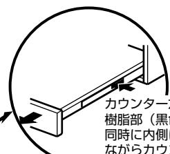
カウンター左右の樹脂部（黒色）を同時に内側に押しながらカウンターを引くと、ロックが解除されます。
