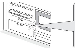
〈点滅〉 ……電池交換サインが点滅したら、コンロやグリルが使用できなくなる場合がありますので、新しい単1形アルカリ乾電池(1.5V)2個と交換してください。
