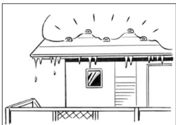
建物の屋根から落雪のおそれのある場所に屋外鉄骨階段廊下ユニットを設置している場合は必ず建物の屋根に「雪止め処置」を施してください。「雪止め処置」が施されていませんと建物の屋根からの落雪により屋外鉄骨階段廊下ユニットが破壊するおそれがあります。
