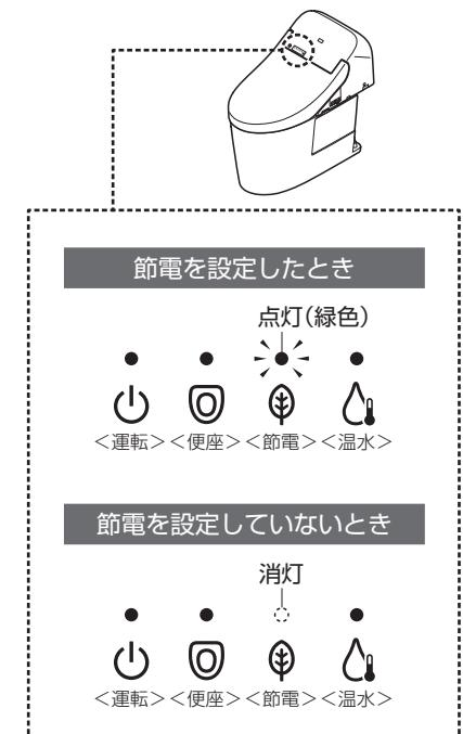
●節電がはたらいているとき（便座ヒーター「低温」または「切」、温水ヒーター「切」）でも、便座に座ると一時的に温かくなります。（便座は約15分間、温水は約10分間で設定温度になります。）（ウォシュレット本体表示部は、節電を設定したときのランプ表示に戻ります。）
