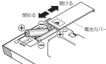
●乾電池を正しくセットすると、リモコンの全ランプが約2秒間点灯します。
