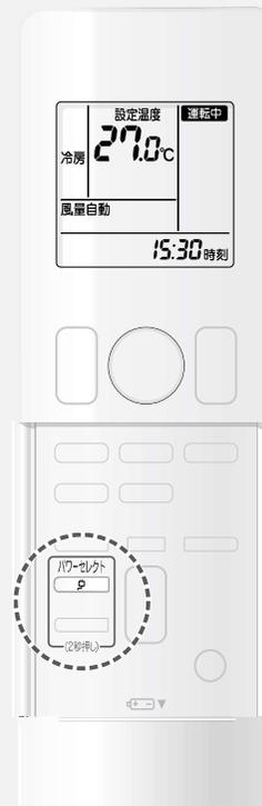
運転時の電流を制限して\*、電力消費を抑える機能です。
