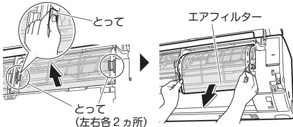
エアフィルターを取り付けずに運転したり、傷ついた状態で運転しないでください。故障の原因となります。
