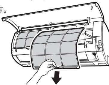
**B3** 光触媒集塵・脱臭フィルターとエアフィルターを取り付ける。
