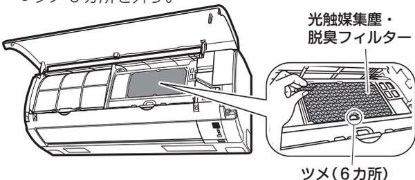
**B3** 光触媒集塵・脱臭フィルターとエアフィルターを取り付ける。
